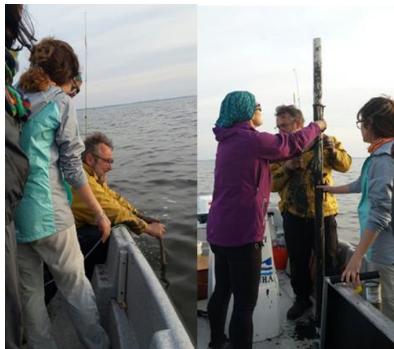
Fig. 2: Extracción del testigo sedimentario TLP-17-I y II
